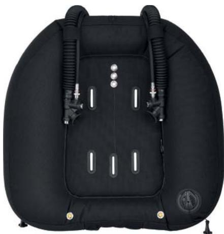
Это двухкамерное крыло предназначено для использования со спаркой и обеспечивает 27 кг подъемной силы. Имеет две внутренних камеры в одной внешней оболочке. Каждая камера по отдельности может наполняться до объема 27 л. Использование подобной резервной системы обеспечивает дополнительную безопасность.
